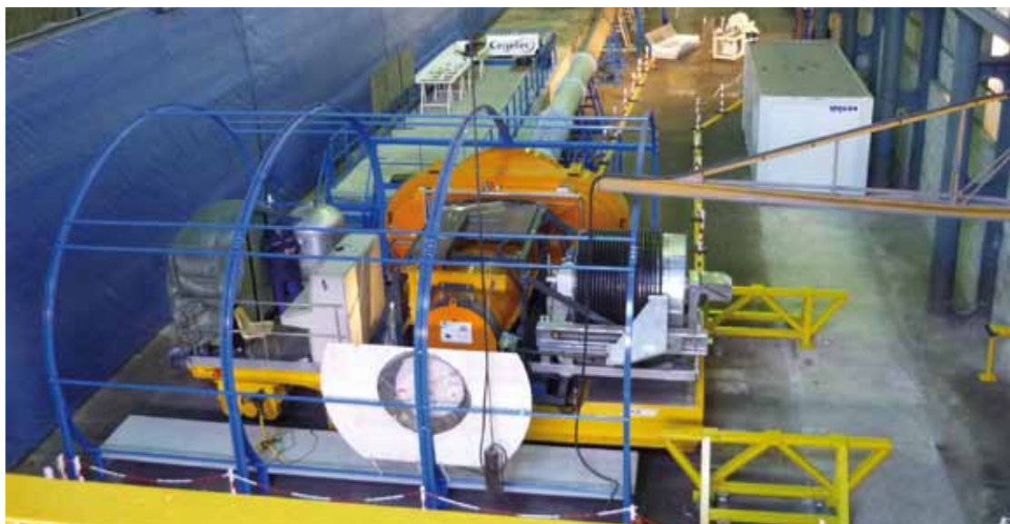
● Banc d'essai du robot pousseur, test de mise en place et de retrait de colis
